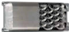
Mini reattore per test in scala costruito in acciaio inox LaserForm 17-4PH (A)
